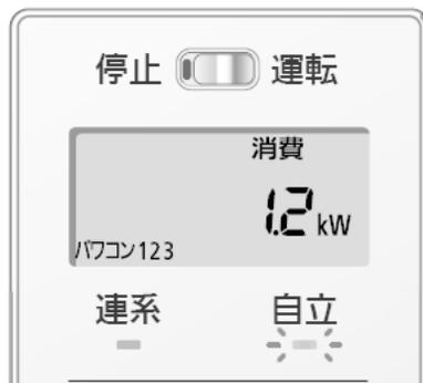
※自立運転時の電力表示は自立運転コンセントに接続された機器の消費電力（単位：kW）です。
