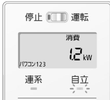
※自立運転時の電力表示は自立運転コンセントに接続された機器の消費電力（単位：kW）です。（図は1.2kWの例）
