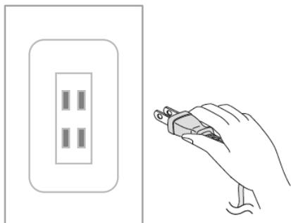
※復電時は自動的に通常運転（発電モードは停電前状態、浴室排水設定は「切」(工場出荷時設定)）に戻ります。
